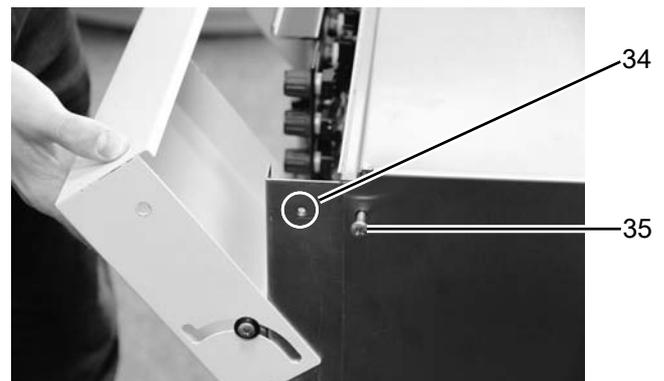
2. Heben Sie die Frontklappe leicht an und klappen Sie die Frontklappe dann auf.
