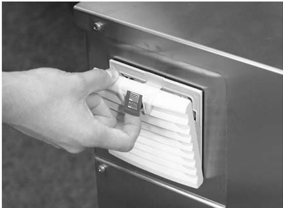
2. Tauschen Sie den Filter bei Verschmutzung. Schließen Sie die Klappe anschließend wieder, bis sie einrastet.
