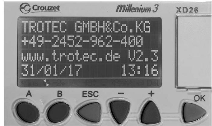
Mit den Tasten **A** und **B** kann die Anzeige durchgeblättert werden. Damit werden folgende Displays aufgerufen:
