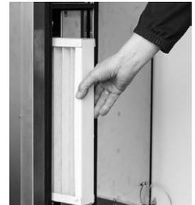
3. Prüfen Sie, ob der Filter für die Schaltkastenbelüftung eingesetzt ist:
