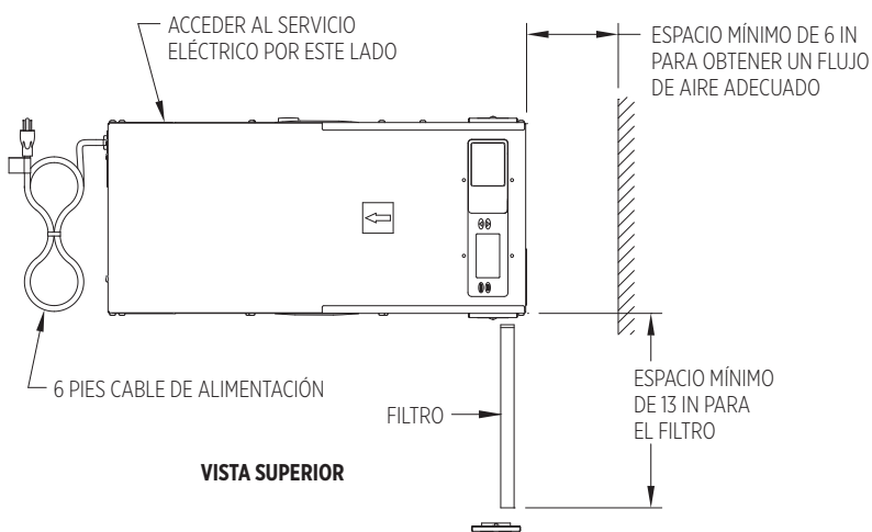
FIGURA 2: SEPARACIÓN PARA ACCEDER AL FILTRO
