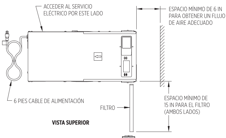
FIGURA 2: SEPARACIÓN PARA ACCEDER AL FILTRO
