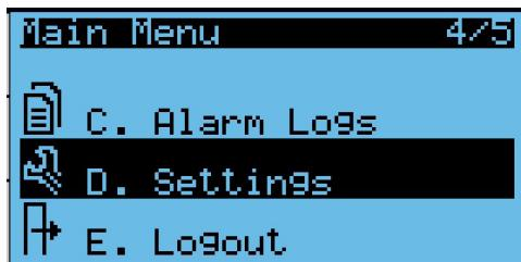
3. Presione Introducir para ingresar al menú de Settings (Configuración). Luego, presione las teclas Arriba/Abajo hasta que se resalte Date/Time (Fecha/Hora).
