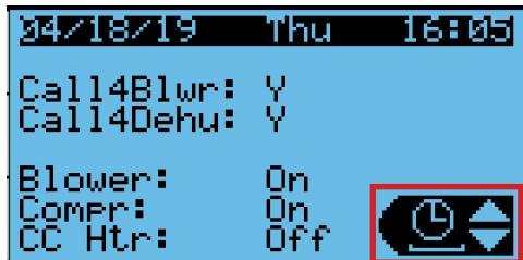
2. Presione Introducir para mostrar las horas de funcionamiento de toda la unidad (compresor o ventilador), del soplador y del compresor.
